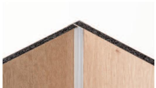
Das zweite **RESOPAL SpaStyling® BOARD** wird vor der Wand auf 3 mm Distanzhalter aufgesetzt, in das Eckprofil eingeschoben und anschließend in das Klebbett gedrückt. Die Verbindung zwischen Profil und der **RESOPAL SpaStyling® BOARD** muss wasserdicht ausgeführt werden. Profilklebstoff, der aus den Profilen ausgequollen ist, muss sofort von der Oberfläche entfernt werden.
